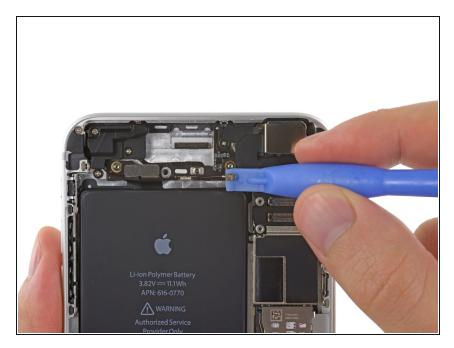
Retirez soigneusement le connecteur d'antenne Wi-Fi 5GHz sur la carte logique avec un outil d'ouverture en plastique.
