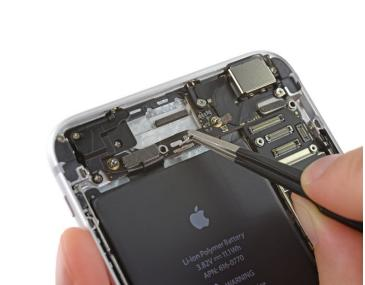
Saisissez le connecteur d'antenne Wi-Fi 5GHz avec une pince et retirez-le doucement de son clip de retenue sur la carte logique.
