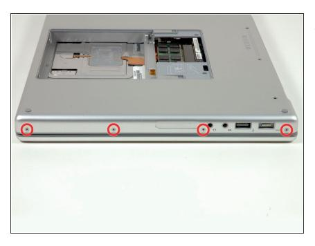
Faites encore pivoter le MacBook de 90° et dévissez les quatre vis cruciformes de 3,2 mm sur le côté de l'ordinateur.
