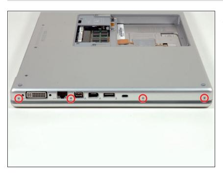
Dévissez les quatre vis cruciformes de 3,2 mm sur le côté des ports de l'ordinateur.
