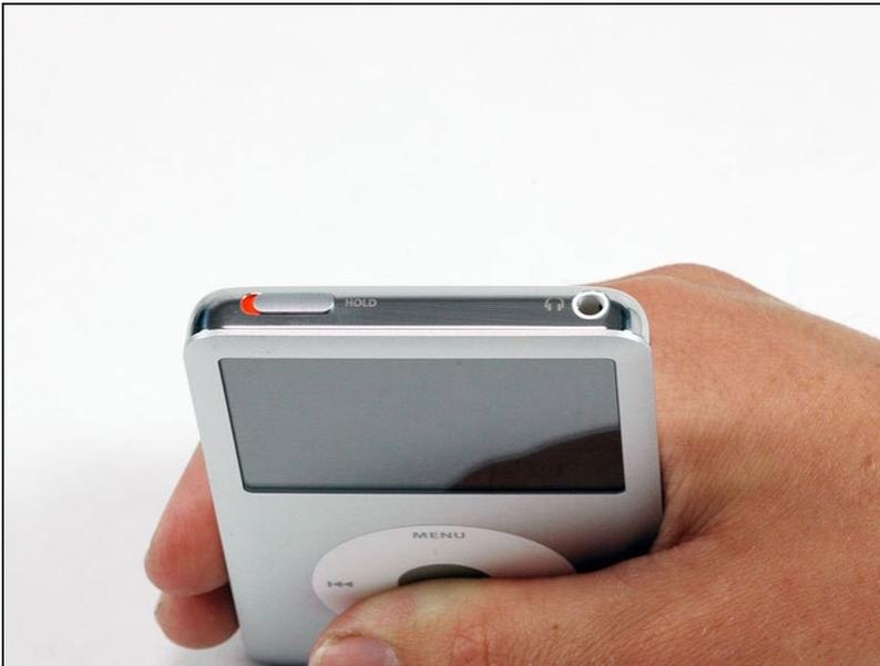
**⚠ Entlade zur Sicherheit den iPod komplett, bevor du das Gerät öffnest.** Dadurch verringert sich das Risiko eines Brandschadens, wenn der Akku während der Reparatur versehentlich angestochen wird. Wenn der Akku aufgebläht ist, musst du [geeignete Sicherheitsmaßnahmen treffen](#).
