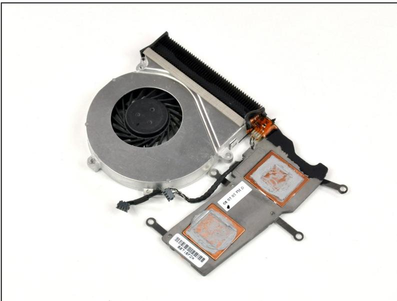
⚠️ 放熱グリスはプロセッサからヒートシンクへ熱を伝える役割をしています。放熱グリスを塗付しないでコンピューターを再組み立てると、プロセッサがオーバーヒートしてしまい、永久的なダメージにつながります。
